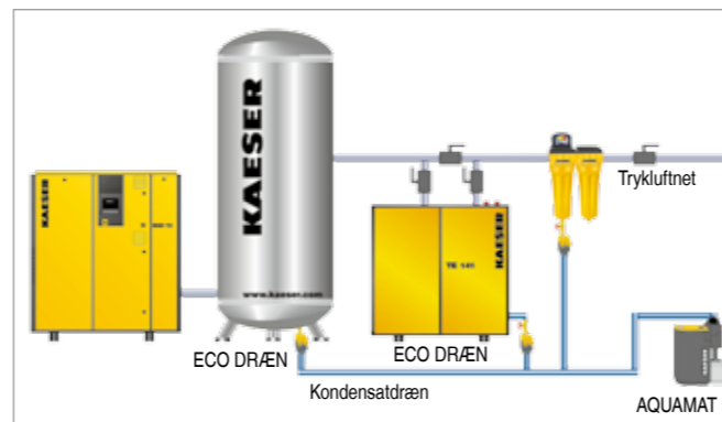
Fra alle kondensatsamlingssteder i luftsystemet skal der kunne foretages pålidelig dræning. Dette sikres bedst ved hjælp af elektronisk kontrollerede kondensatdræn.
