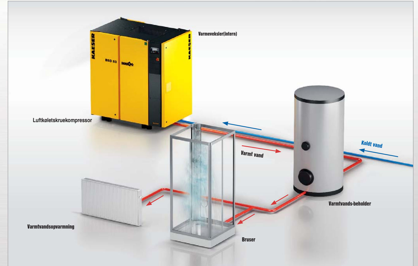
Fig.: Skema over varmegenvinding
